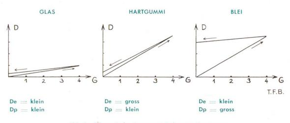
Abb. 2 Schematische Spannungs-Dehnungs-Diagramme
