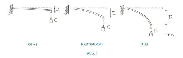
Erfolgt die **Be**lastung und nachher die **Ent**lastung stufenweise, so können die Beobachtungen graphisch aufgezeichnet werden. Es entsteht ein Spannungs-Dehnungs-Diagramm.
