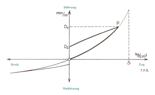
Abb. 3 Schematisches Spannungs-Dehnungs-Diagramm für Beton
