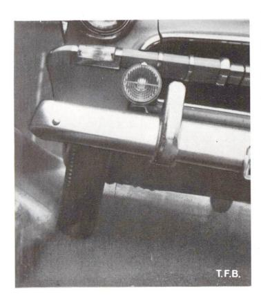
Abb. 7 Praktische Wirkung der Leitschranke auf das Fahrzeug
