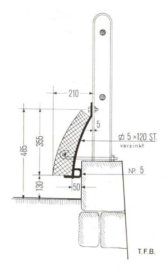
Abb. 2 Schema für Befestigung der Leitschranke an Sockel mit Geländer
