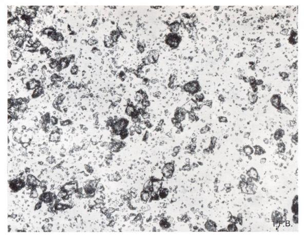
Abb. 2 Mikroaufnahme einer Spezialcementprobe in 190facher Vergrösserung
