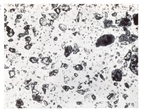
Abb. 1 Mikroaufnahme einer Normalcementprobe in 190facher Vergrösserung
