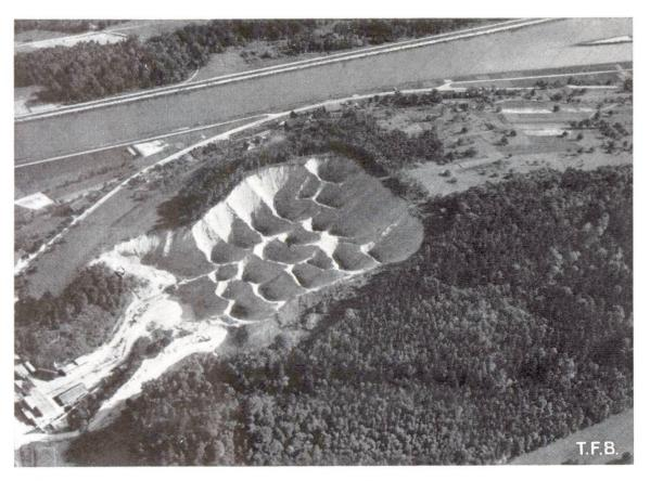
Abb. 5 Flugaufnahme eines Steinbruches mit Rollochbetrieb
