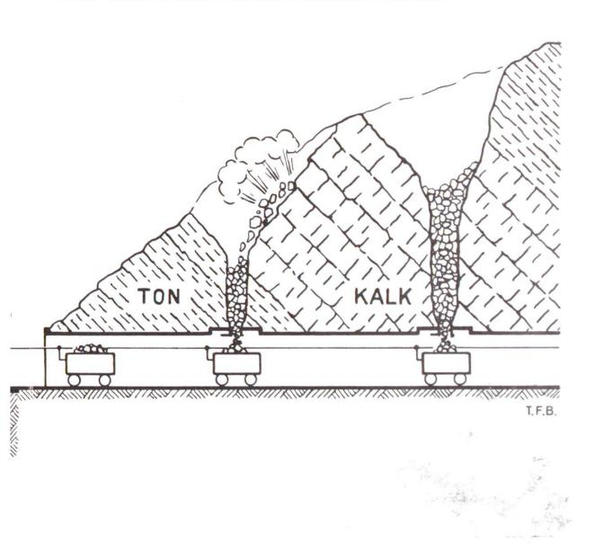
Abb. 4 Rollochbetrieb mit Rollwagen, Brecher und Seilbahn
