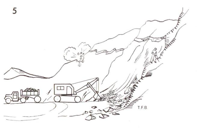
Abb. 3 Tagbau mit Bagger, Lastwagen, Brecher und Transportband
