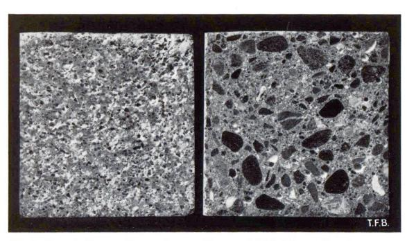
Abb. 2 Querschnitte von altem und neuem Normenmörtel (leicht vergrössert)
