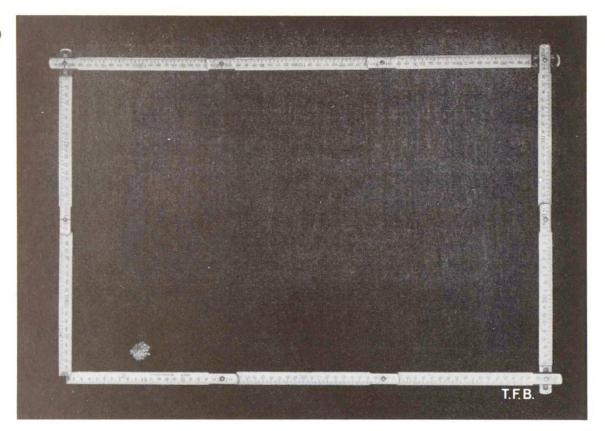
Abb. 4 Innere Oberfläche von Cementmehl. Die in 1 Gramm Cement (links unten im Rechteck) enthaltenen Teilchen haben zusammen eine Oberfläche von in der Regel über 2400 cm² (~ 1/4 Quadratmeter). Diese Oberfläche wird mit dem sogenannten Permeabilimeter bestimmt
