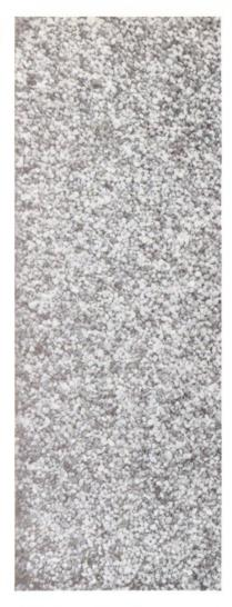
Abb. 1 Alter Normensand, einkörnig, aus der Grube von Oberdiessbach
