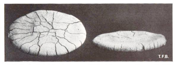
Abb. 3 Raumbeständigkeitsproben, durchgeführt mit einem gesunden und mit einem treibenden Bindemittel
