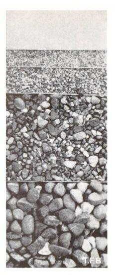
Neuer, abgestufter Normensand. 3 Fraktionen von 0–5 mm, aus der Grube Möriken-Wildegg (Aufnahme leicht vergrössert)
