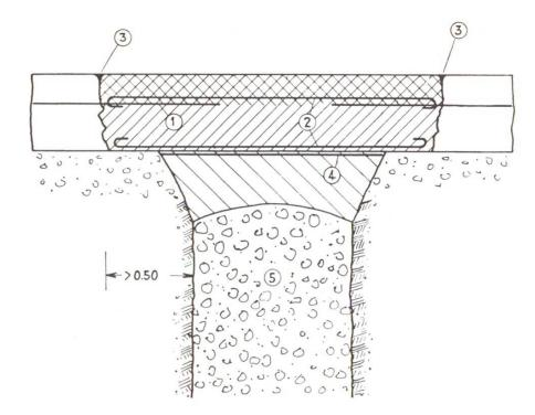
Abb. 13 Ausbildung des Einbaues einer Aufbruchstelle:
