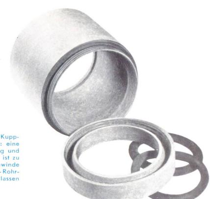
Abb.5 Die "Simplex"-Kupplung mit Schraubring: eine Muffe, ein Schraubring und zwei Gummiringe. Es ist zu beachten, dass sich Gewinde in das Asbestcement-Rohrmaterial schneiden lassen
