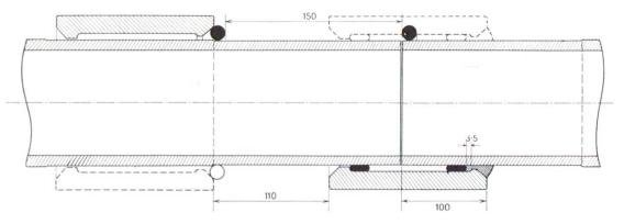
Abb. 2 Die einteilige "Simplex"- Kupplung im Schnitt. Ausgangs- und Endlage von Kupplung und Gummiringen sind gezeigt; kreuzweise schraffiert die notwendige Vermörtelung
