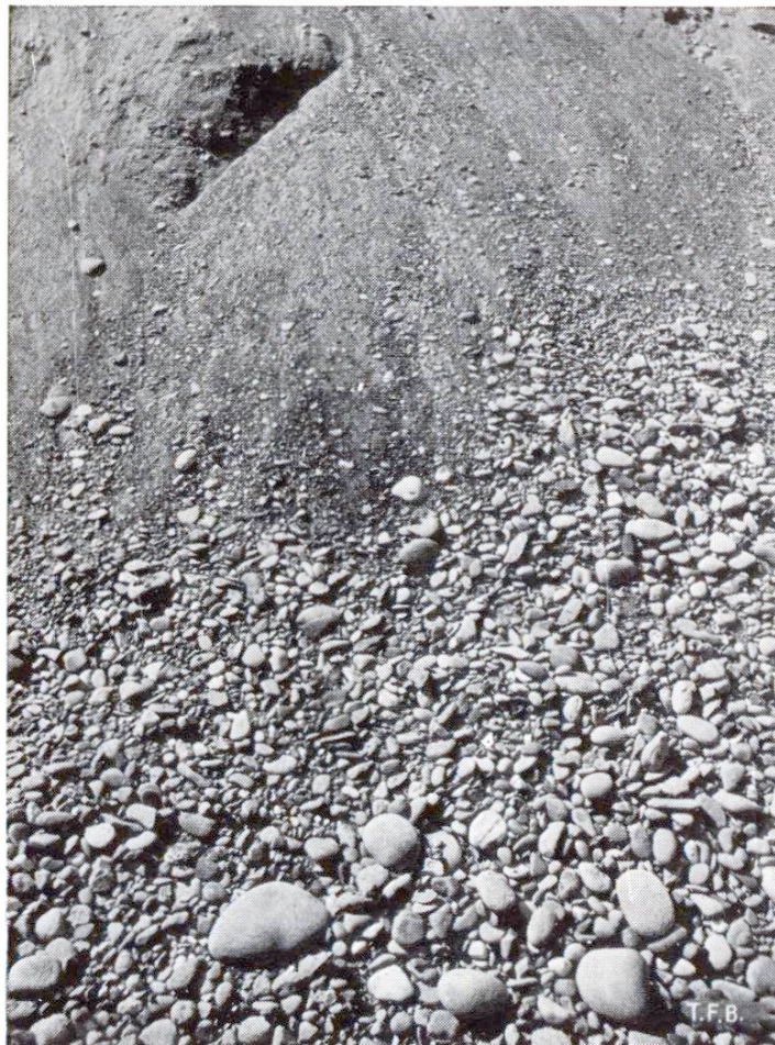
Abb. 4 Entmischung an einer Deponie von Sandkies
