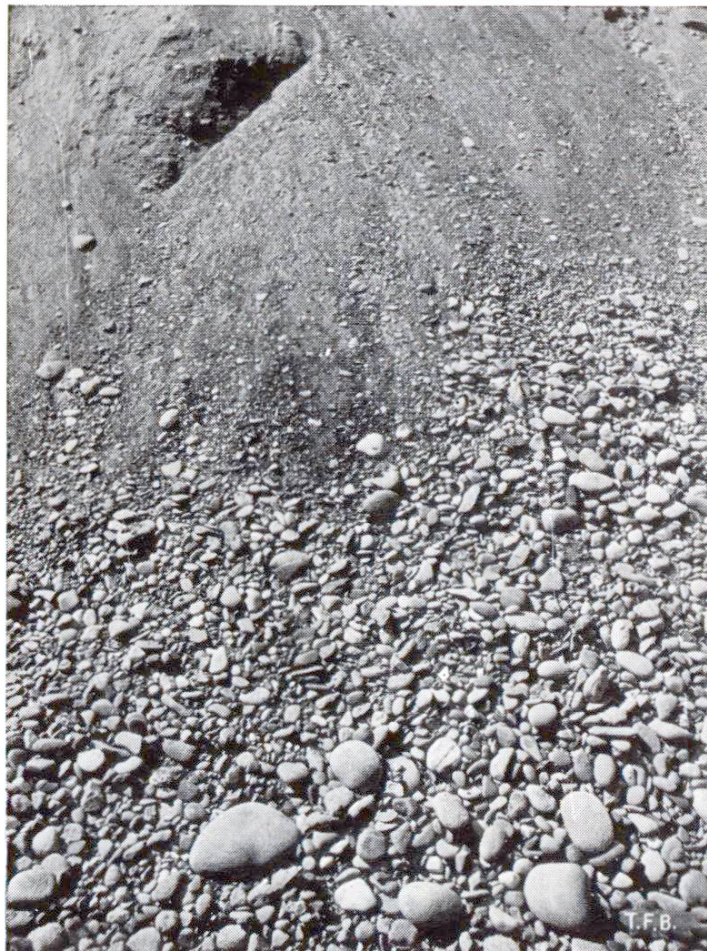
Abb. 4 Entmischung an einer Deponie von Sandkies
