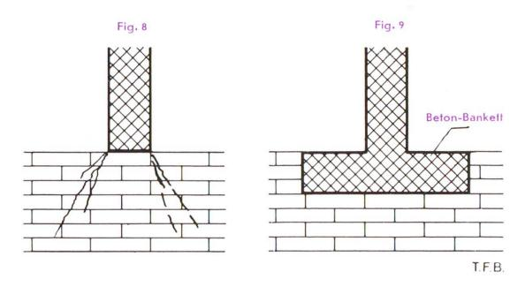
c) Riss- und Kippgefahr bei kleinen Stützmäuerchen, wo auf lange Sicht die Wirkung des Erddruckes unterschätzt wird, und oft zu geringe Dimensionen für Fundament und Mauer gewählt werden.
