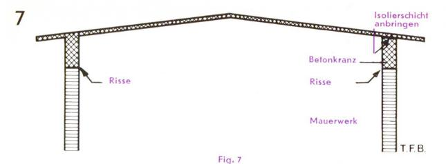
Gewände und Umlaufträger, so dass vor allem Risse an der Kontaktfläche zwischen Betonkranz und Mauerwerk auftreten (Fig. 7).
