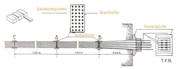
Abb. 2 Prinzip der Verankerung nach Magnel mit vier Eisenkeilen für je acht Drähte (Sandwichplatten)
