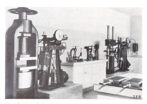
Abb. 2 Pressen zur Prüfung von Beton- und Cement-Prismen
