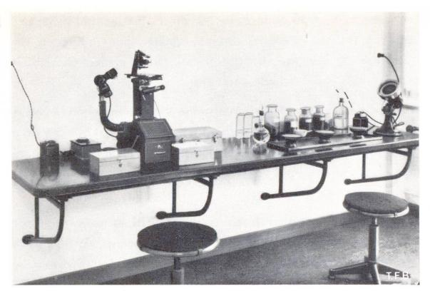
Abb. 3 Mikroskop zur kristallographischen Untersuchung des Klinkers
