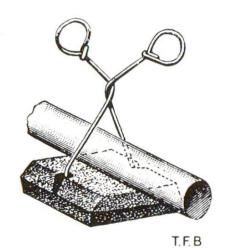
Abb. 6 Unterlagsplaste aus dichtem Mörtel und Drahtbefestigung zur Sicherung eines minimalen Abstands der Armierung von der Betonoberfläche
