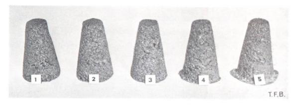
Abb. 4 Harsche Mischungen ergeben in der Setzprobe keinen Unterschied, ob sie mit viel oder wenig Wasser gemischt wurden. In der nässesten Probe läuft der Feinmörte! aus dem ein Gerüst bildenden Grobzuschlag heraus
