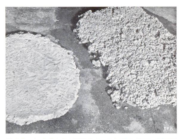
Abb. 2 Die unterschiedliche Streichfähigkeit einer geschmeidigen Mischung (links) und einer harschen Mischung (rechts) macht sich im Schliessen der Oberfläche und der Ausbreitränder bemerkbar
