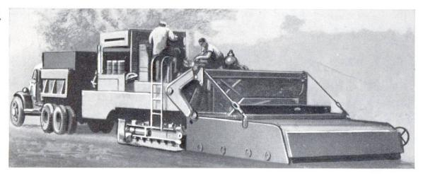
Bodenmisch- und Verteilergerät
