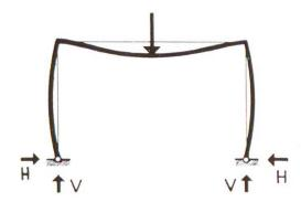
Abb. 3 Vollständige Einspannung der Widerlager
