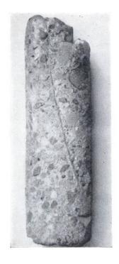
Abb. 4 und 5 Bohrkerne durch Arbeitsfugen
