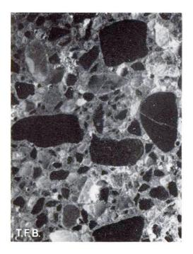
Abb. 2 Die Körner des Zuschlagsmaterials sind im Cementleim dauerhaft eingebettet. Teilweise wirkt der Cementleim auch als Füllmaterial
