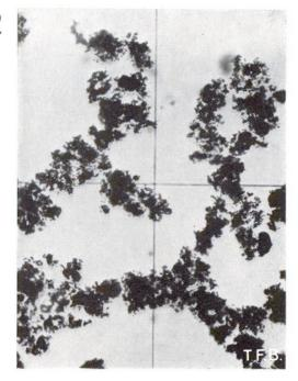
Abb. 1 Selbst in verdünnter Aufschlämmung macht sich nach kurzer Zeit die Bindekraft des Cements geltend. Die einzelnen Cementkörnchen lagern sich zu kettenförmigen Gebilden zusammen (stark vergrösserte Aufnahme)
