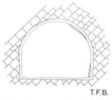
Abb. 6 Betonierter Tunnel, Eisbildung in Form von Wülsten, die Fahrbahn nicht gefährdend
