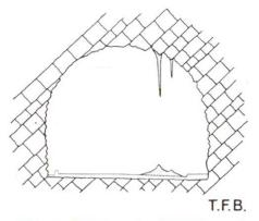
Abb. 7 Felstunnel, Eisbildung in Form von Zapfen, in die Fahrbahn hineinragend
