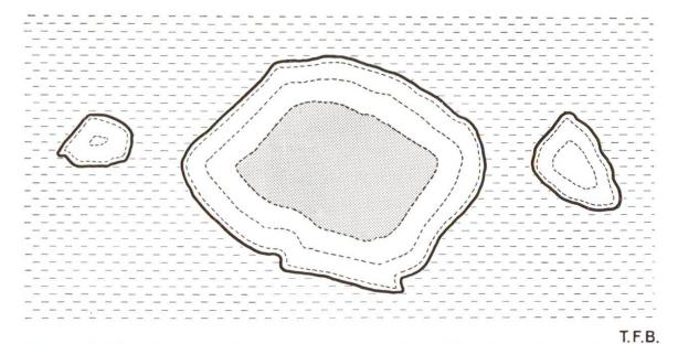
Abb. 1 Die Einwirkung des Anmachwassers auf die Cementkörnchen nach verschiedenen Zeiten (stark vergrössert)
