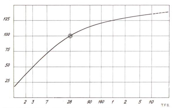
Abb. 2 Festigkeitsverlauf mit zunehmendem Alter des Betons.
