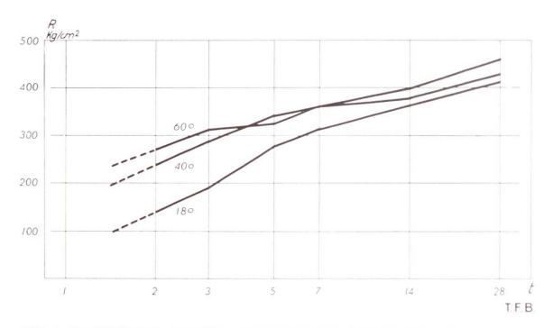
Abb. 3 Druckfestigkeiten von Beton bei verschiedenen Erhärtungstemperaturen
