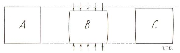
Abb. 1 Beim Zusammendrücken eines starren Körpers A erleidet er Formänderungen von vorübergehendem und bleibendem Charakter. Das Stadium B zeigt in stark übertriebener Weise die Verkürzung in der Druckrichtung und die Querdehnung. Bei C nach der Entlastung, der grössere Teil der Verformung ist wieder verschwunden
