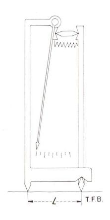
Abb. 3 Messinstrument mit doppelter Hebelübersetzung. Kleine Änderungen der Strecke L bewirken einen erheblichen Zeigerausschlag
