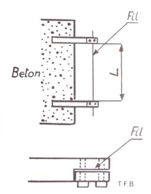
Abb. 5 Bestimmung der Längenänderungen mittelst im Beton verankerter und gespannter Stahlsaite. Kleinste Spannungsänderungen bewirken eine Veränderung der Saitenschwingungen, die elektrisch gemessen werden.
