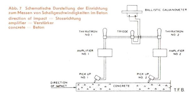
die Ausbreitgeschwindigkeit von Schallwellen im Beton rasch und genau zu ermitteln (Abb. 7), womit ein wertvoller Beitrag zur zerstörungsfreien Betonprüfung geleistet worden ist. Die **Schallgeschwindigkeit** im Beton ist nämlich ein gutes Kriterium für dessen Festigkeits- und Elastizitätseigenschaften.
