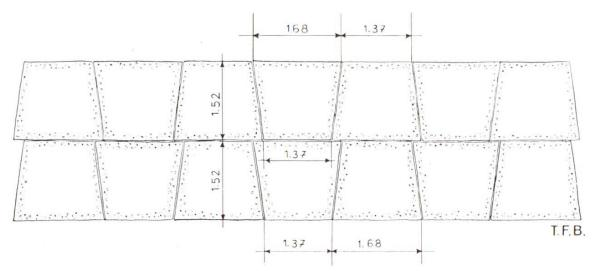
Abb. 3 Querschnitt durch die Balken-Schutzdecke eines Synchrocyclotrons
