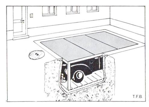
Abb. 7 Boxe versenkt unter Terrain
