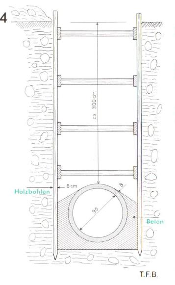
Abb. 3 Der Ummantelungsbeton wird an die Holzbohlen anbetoniert
