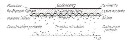
Als indirekter Vorteil der Massivbauweise ist zu werten, dass in der Regel ein zusätzlicher Schallschutz leichter und billiger auszuführen ist als bei anderen Bauweisen. Solche **zusätzlichen Massnahmen** können z. B. erforderlich werden beim Einrichten von häuslichen Gewerben, Mechanisierung von Bureauarbeiten, Aufteilen von Wohnungen etc., also häufiger, als meist angenommen wird.
