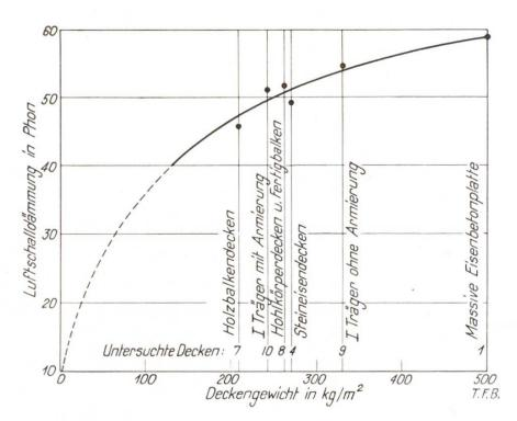
Abb. 1 Luftschallisolierung in Funktion des Deckengewichts. Freigelagerte Decken von 4.20 m Spannweite
