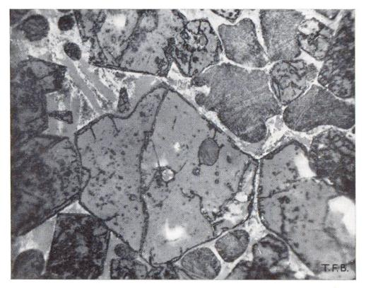
Abb. 4 Mikroskopisches Bild des Anschliffs von Portlandcementklinker (Vergrösserung 540fach). Die grossen 6kantigen Tafeln sind Alit-Kristalle, die abgerundeten Körner mit gekreuzter Lamellen-Zeichnung bestehen aus Belit. In der Glasschmelze zwischen den Alit- und Belit-Kristallen erkennt man weitere Mineralien
