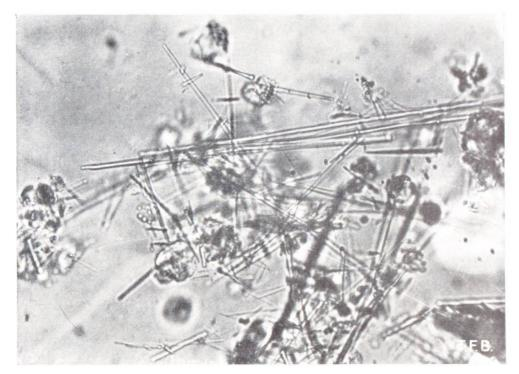
Abb. 5 Mikroskopisches Bild von langen Nadeln von Aluminaten, Sulfoaluminaten und Carboaluminaten, die sich nach 3 jähriger Erhärtung der Cementmineralien bildeten (Vergrösserung 580 fach)
