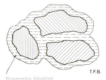
Abb. 2 Hydratation der Oberfläche und Bildung der Gelschicht
