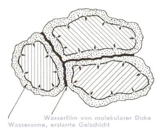
Abb. 3 Erhärtung der Gelschicht: Abwanderung des Wassers in das Innere des Kornes und Bildung dünner Wasserfilme, die Kohäsions-Kräfte bewirken
