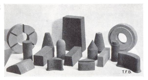
Abb. 1 Schleifsteine verschiedener Formen und Schärfen. Vorn rechts sog. Handrutscher. Links hinten Schleifringeinsatz. In der Mitte Schleifkonusse
