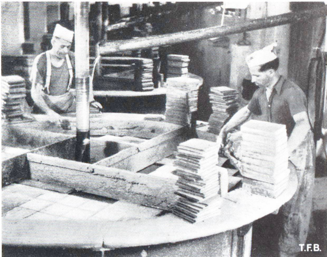
Abb. 4 Schleifmaschine mit untenliegender Arbeitsscheibe für Bearbeitung von Bodenplatten
