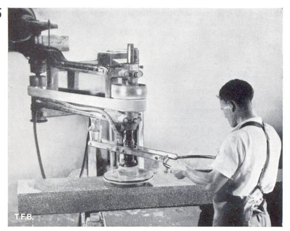
Abb. 5 Polieren mit schwenkbarer Wandarm-Maschine
