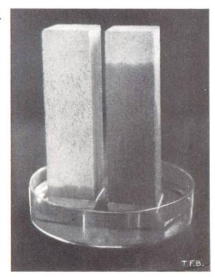
hältnis zu ihrer Grösse nur sehr wenig Verbindung mit den Aussenflächen haben. Solche Poren können durch eingeschlossene Luftblasen oder durch sog. Wasserlinsen (innere Abscheidung von Anmachwasser während des «Anziehens») entstanden sein. Bei langer Lagerung im Wasser füllen sich diese Poren mit Flüssigkeit, ein Beweis, dass sie in keinem Fall völlig «geschlossen» sind.
