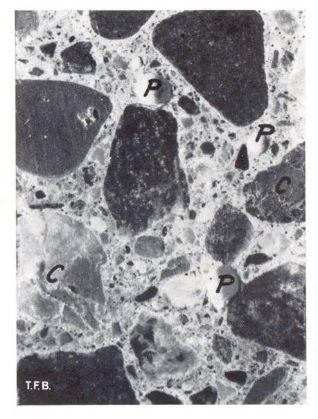
Abb. 2 Polierter Querschnitt durch wasserdichten Cementmörtel, 10 × natürl. Grösse. Ausschlaggebend für die Durchlässigkeit ist die Kapillarität, bzw. Dichte des die Steine umhüllenden Cementleims. P = einige sog. geschlossene Poren. C=einigeoffene Poren in den Sandkörnchen
