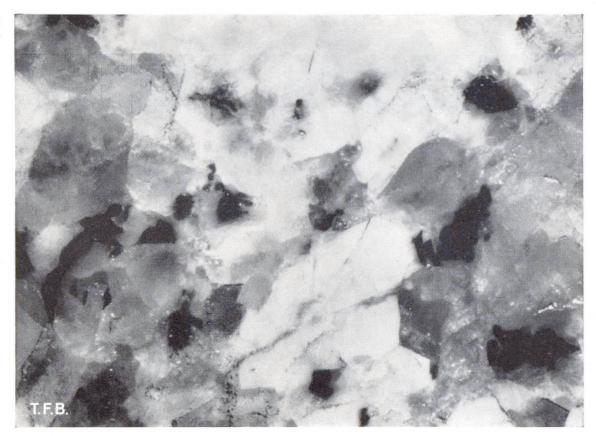
Abb. 1 Polierler Anschliff von Granit. Vergrösserung 10 × linear zur Sichtbarmachung der Korngrenzen
