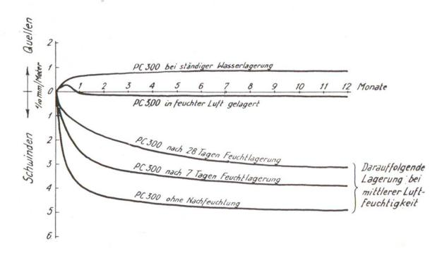
Abb. 3 Freies Schwinden von Beton P. 300 in Abhängigkeit von Nachbehandlung und Lagerungsbedingungen
