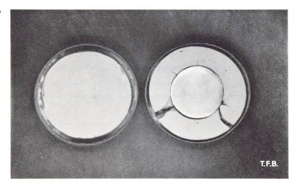
Abb. 5 Modellversuche mit Lehm. Links "freies", rechts durch starre Einlage "behindertes" Schwinden
