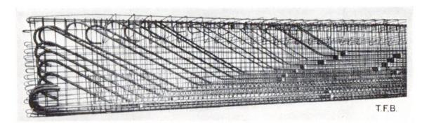
Abb. 5 Aufgelöste Armierung für einen Eisenbetonträger. (EMPA-Bericht No. 99 5)
