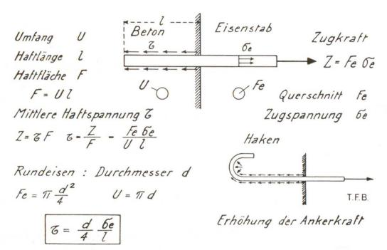
Abb. 1 Haftspannung 7 eines auf die Länge / (= Haftlänge) einbetonierten und auf Zug beanspruchten Eisens. Die Haftspannung (nicht zu verwechseln mit der Haftfestigkeit I) ist dem Durchmesser des Eisens proportional.
