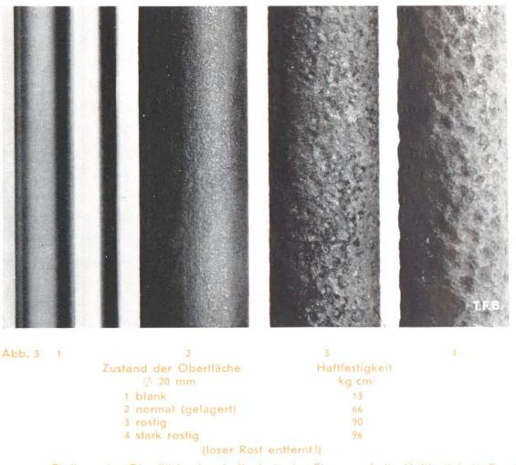
Einfluss der Oberflächenbeschaffenheit des Eisens auf die Haftfestigkeit. Rundeisen Ø 20 mm. Haftlänge 20 cm. Hochw. Beton. (XXXII. Jahresbericht 1942 des Vereins schweiz. Cement-, Kalk- und Gipsfabrikanten)
