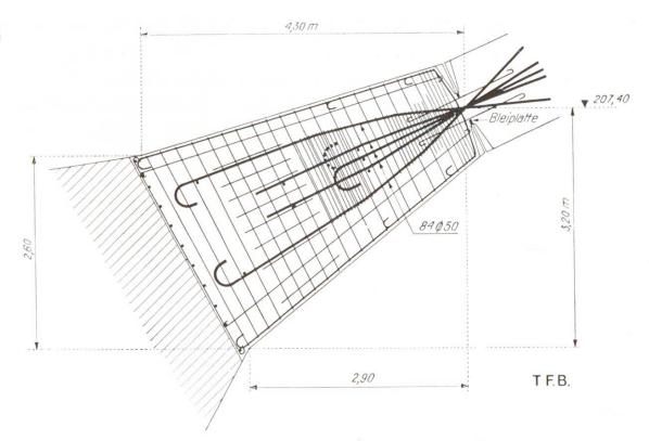
Abb. 2 Kämpfergelenk der Maggiabrücke bei Locarno als Federgelenk ausgebildet (EMPA-Bericht Nr. 99)
