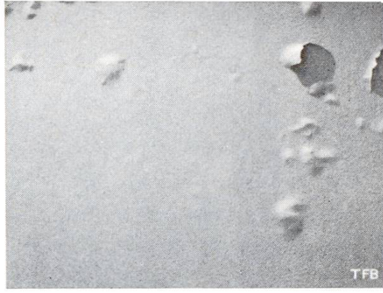
Abb. 5 Blasenbildung an einem Oelanstrich
