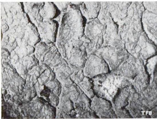
Abb. 4 Zersetzung eines Ölfarbanstrichs auf frischer, unbehandelter Cementunterlage
