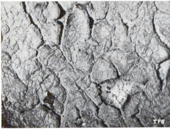
Abb. 4 Zersetzung eines Ölfarbanstrichs auf frischer, unbehandelter Cementunterlage
