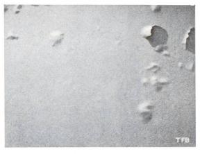
Abb. 4 Zersetzung eines Oelfarbanstrichs Abb. 5 Blasenbildung an einem Oelanstrich auf frischer, unbehandelter Cementunterlage
