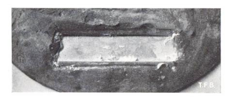
Abb. 2 In Cementbrei eingebettetes Aluminiumblech. Die Bildung weisser Zersetzungsprodukte ist am Blechrand erkennbar.
