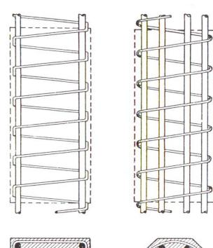
Abb. 3 Umschnürter Beton (béton fretté) nach Considère.
