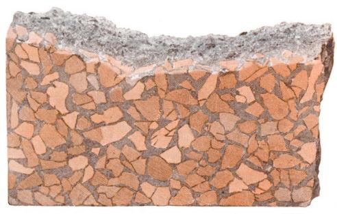
Abb. 4 Querschnitt durch eine gefärbte Terrazzoplatte
