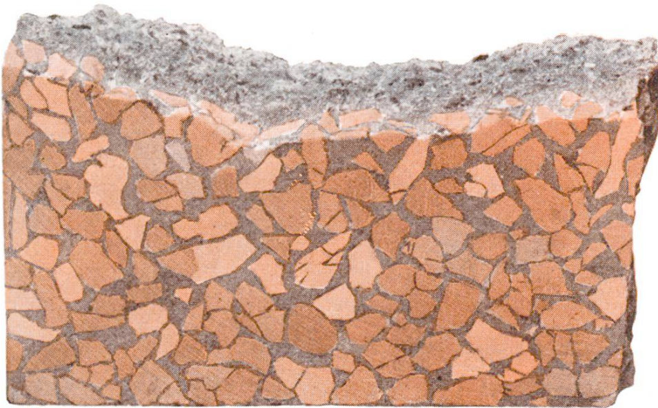
Abb. 4 Querschnitt durch eine gefärbte Terrazzoplatte
