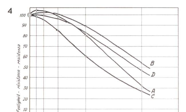
Abb. 3 Einfluss verschiedener Farbzusätze, wechselnd von 0-16% des Cementgewichts, auf die Festigkeit von Mörtel 1:3 A = Amerikanischer Gasruss, B = Chromoxydgrün, C = Ocker G, D = Ultramarin
