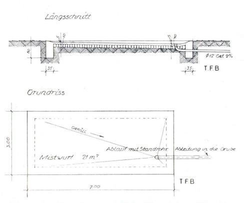
Abb. 5 und 6 Mistwurf von 21 m² Fläche, Längsschnitt und Grundriss
