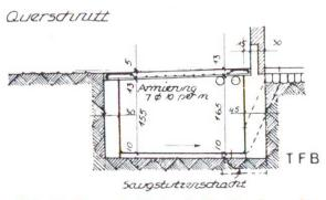
Abb. 4 Querschnitt durch die Jauchegrube
