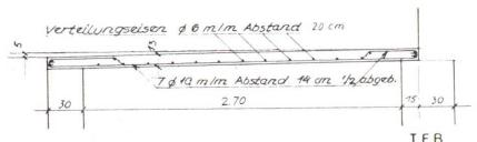
Abb. 3 Abdeckung der Jauchegrube mit einer Eisenbetonplatte
