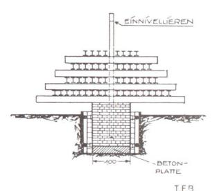
Abb. 3 Probebelastung des Bodens und Belastung-Einsenkungsdiagramm. Von ca. 9 kg cm² an nimmt die Setzung rascher zu als die Laststeigerung. Zulässige Bodenpressung 3 kg/cm²; 3fache Sicherheit (aus J. Schultze; der Grundbau, Samml. Göschen Nr. 990)
