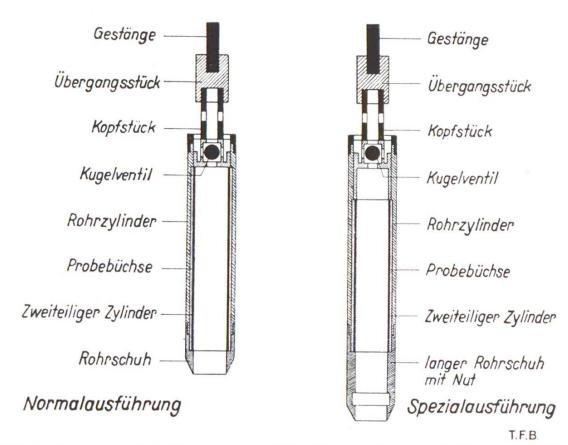
Abb. 2 Apparat zur Entnahme von ungestörten Bodenproben (aus Kollbrunner, s. Lit.)
