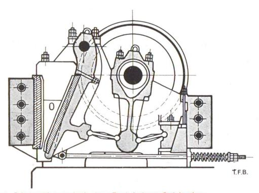
Abb. 3 Schnittzeichnung durch einen Zweischwingen-Steinbrecher
