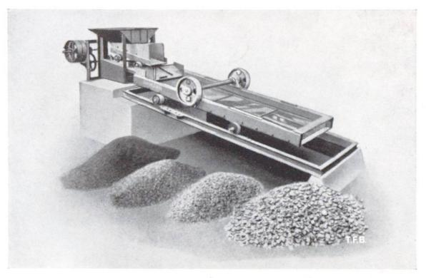
Abb. 8 Vibrations- (Rüttel-, Schwing-) Sieb mit automatischem Beschickungsapparat
