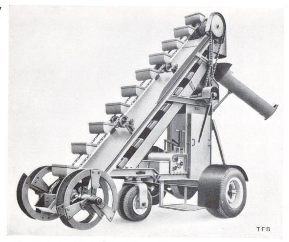
Abb. 9 Mechanisches Verladegerät mit Material-Zulaufschnecken
