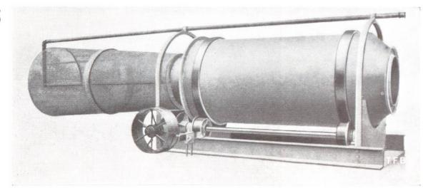
Abb. 5 Waschmaschine mit angebauter, konischer Nachsortierung und Abspritzvorrichtung
