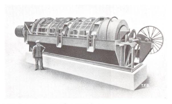
Abb. 6 Trogwaschmaschine mit Unterwassersortierung
