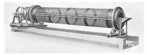
Abb. 7 Sortiermaschine mit 4 Feldern
