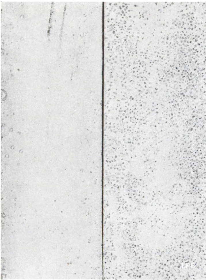
Abb. 4 Beregnungsversuch an Portlandcementmörteln 1 : 3 Links ohne Beregnung. Rechts nach Einwirkung einer Regenmenge, die innert eines Zeitraums von 100 Jahren zu erwarten wäre
