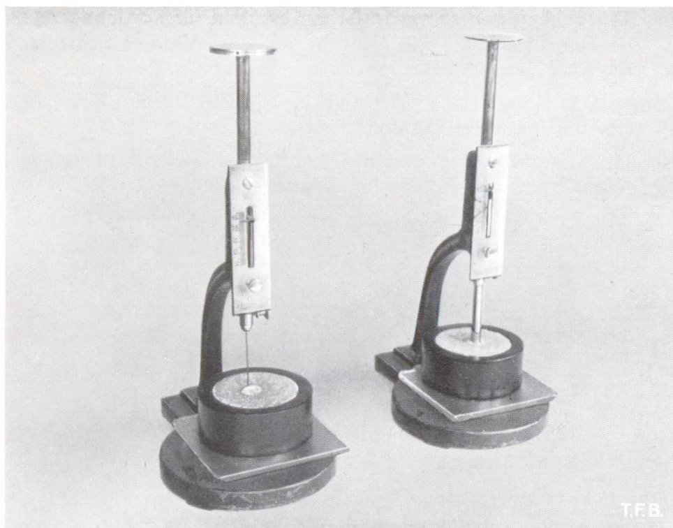
Abb. 2 Vicat-Apparat. Rechts mit Einrichtung zur Konsistenzmessung des zu prüfenden Cementbreis. Links mit Nadeleinsatz ( 1 \text{ mm}^2 Querschnitt) für die Ermittlung der Abbindezeiten
