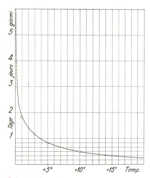
Abb. 1 Einfluss tieferer Temperaturen auf den Abbindeverlauf von Portlandcementen. Unterhalb + 5  $^{\circ}$  C ist die Erhärtung stark verlangsamt
