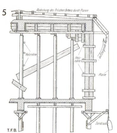
Abb. 4 Abschirmung mit Zeltblachen und Erwärmen mit Heizrohren (aus A. Kleinlogel, s. Lit.)
