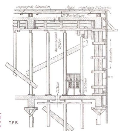
Abb. 3 Abschirmen eines Winterbauwerks mit Brettertafeln und Erwärmen des umschlossenen Raums mit Kokskörben (aus A. Kleinlogel, s. Lit.)
