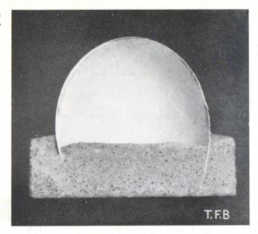
Abb. 1 Schnitt durch eingebettete Eischale. Wanddicke 0,34 mm, Stützweite ~ 40 mm. Die Schale vermag in dieser Versuchsanordnung im Scheitel eine Einzellast von 3,5 Kilogramm zu tragen.
