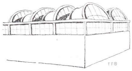
Abb. 6 Dünnwandige, parabolische Schalen für Fabrikhallen.
