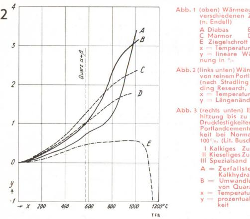
Abb. 1 (oben) Wärmeausdehnung von verschiedenen Zuschlagstoffen B Granit
