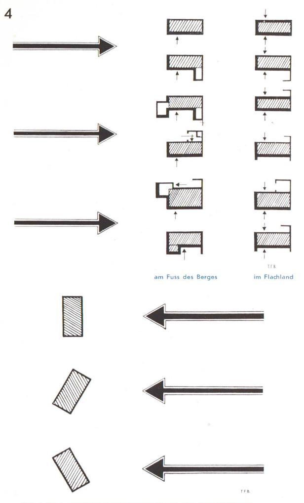
Abb. 3 Haus- und Gebäudeorientierung mit und ohne Berücksichtigung der Windrichtungen (Abb. oben gut; unten schlecht)
