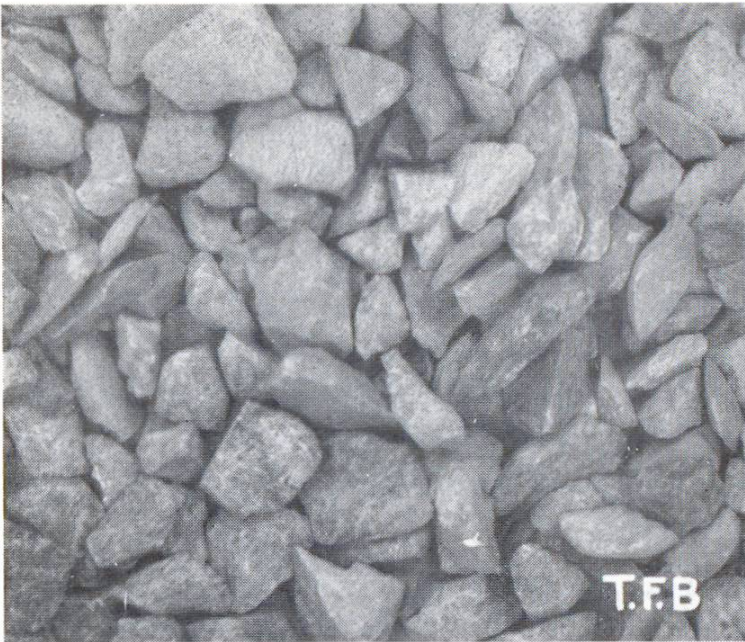
Abb. 2 Gebrochener Betonkies, aufbereitet aus den groben Anteilen von Grubenmaterial
