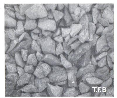
Abb. 2 Gebrochener Betonkies, aufbereitet aus den groben Anteilen von Grubenmaterial
