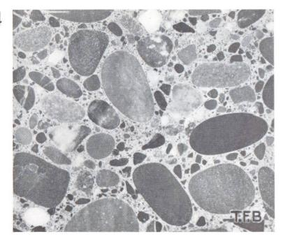
Abb. 3 Querschnitt durch sehr kompakten Qualitätsbeton aus natürlichen Zuschlagstoffen
