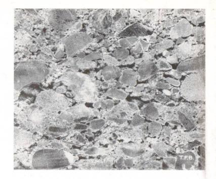
nachträgliche Verdichtungsarbeit meist nicht mehr auszugleichen ist. (Abb. 4.) Zu trockene oder zu nasse (flüssige) Mischungen neigen zu **Nesterbildung** (Sand- oder Kiesnester). (Abb. 5.) Beim «Anlegen» neuer Betonschichten empfiehlt sich die Verwendung fetten Mörtels (1:2) in breiartiger Konsistenz und in 5-10 cm Höhe, in welche Schicht die normale Betonmischung eingestampft wird.
