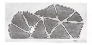
Abb. 6 Schematische Darstellung der Verdichtung von Frischbeton. Die einzelnen mit einer Cementhaut umgebenen Gesteinskörner nehmen unter der Wirkung der Verdichtungsarbeit die gegenseitig günstigste Lage ein
