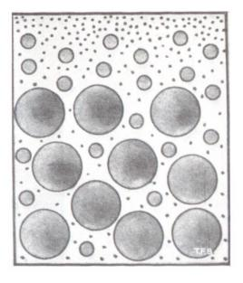
Abb. 4 Schematische Skizze der Entmischung Links: gute Verteilung der feinen und groben Anteile Rechts: weitgehende Materialtrennung
