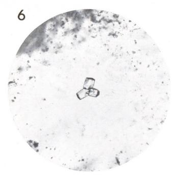
Abb. 7 Aus Alit beim Abbinden ausgeschiedener Kristall-Drilling von Kalkhydrat (Vergrösserung 50-fach)
