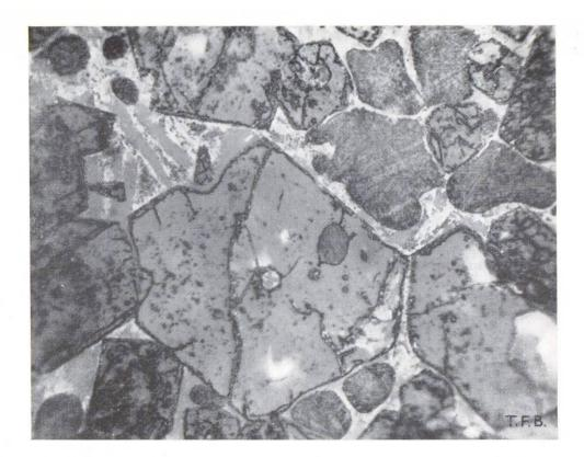
Abb. 6 Mikroskopische Aufnahme (Vergrösserung 540-fach linear) von angeschliffenem Cementklinker. Die grossen sechskantigen Tafeln sind Alit-Kristalle, die abgerundeten Körner mit gekreuzter Lamellenzeichnung bestehen aus Belit. In der Glasschmelze zwischen den Alit- und Belit-Kristallen erkennt man weitere Mineralien
