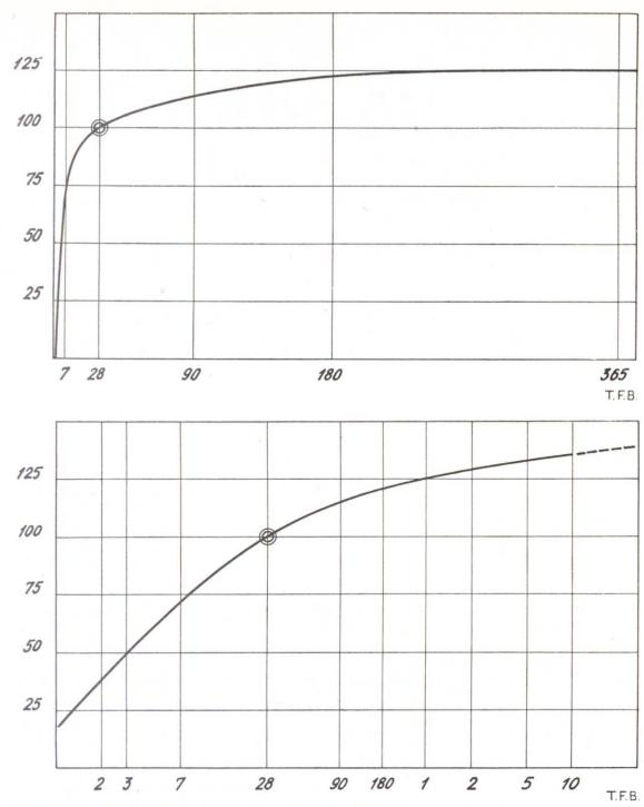
Festigkeitsverlauf mit zunehmendem Alter des Betons
