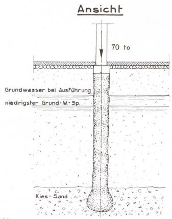
Fig. 7 b Einzelstütze auf 1 Betonortsrammpfahl
