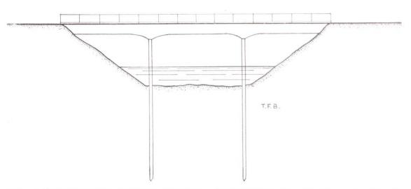
Fig. 6 Fussgängersteg. Joche aus Eisenbeton-Fertigpfählen. Keine Zerstörung im Bereiche des wechselnden Wasserspiegels, im Gegensatz zu Holzpfählen
