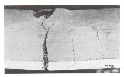
Abb. 2 Vorgespannter Eisenbeton-Probebalken nach dem Bruchversuch. Charakteristische Form der Risse (Schinznacher Versuche S.I.A.)
