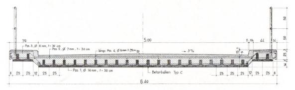
Abb. 5 Detail aus Brückenprofil. Beispiel einer Verwendung von vorgespannten Elementen als Armierung (Neue Granito Bau AG., Zürich)
