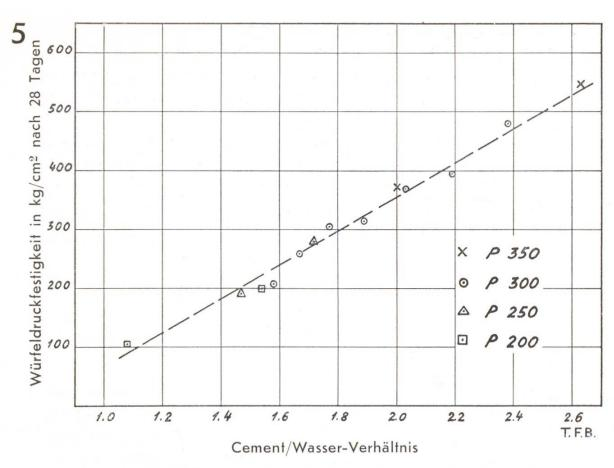
Abb. 3 Beziehung zwischen Festigkeiten und Cement/Wasser-Verhältnissen. Würfeldruckfestigkeit in kg/cm² nach 28 Tagen Cement/Wasser-Verhältnis
